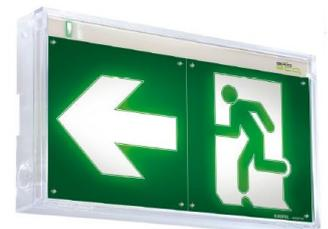
Eclairage d'ambiance: bloc autonome d'ambiance à test automatique intégré SATI 100% LED, saillie, (type KAUFEL BRIO EXO3 40 L A ou équivalent), flux lumineux assigné 250 lm, autonomie 1 heure, avec indice de protection adapté aux risques du local. Selon leur lieu d'implantation, ces blocs autonomes seront pourvus des dispositifs pour fixation murale, en encastré.
