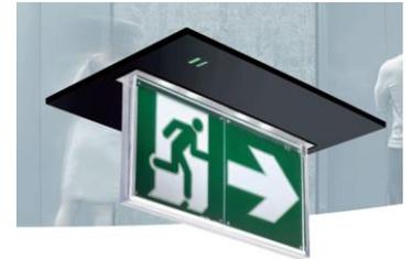
Eclairage d'évacuation escalier de secours: bloc autonome d'évacuation à test automatique intégré SATI 100% LED, saillie (type KAUFEL BRIO ECO3 ou équivalent), flux lumineux assigné 45 lm, autonomie 1 heure, avec indice de protection adapté aux risques du local. Selon leur lieu d'implantation, ces blocs autonomes seront pourvus des dispositifs pour fixation murale, en encastré.
