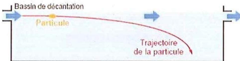
Schéma d'un décanteur horizontal
