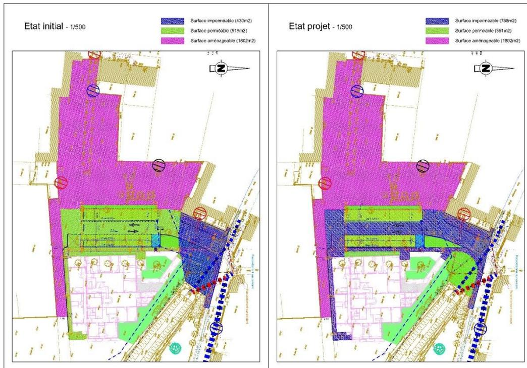
FIGURE 9. PLAN DES SURFACES DE PROJET - ETAT INITIAL ET PROJETE (OTEIS)
